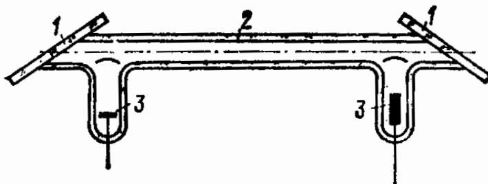
Рис. 1.4. Сечение газоразрядной трубки типичного газового лазера.
