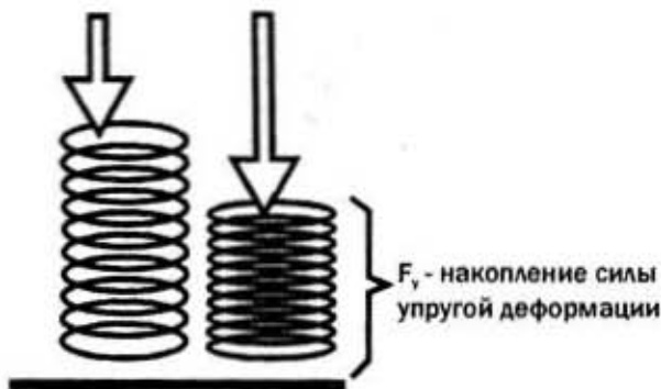
Рис. 16. Сила упругой деформации, ( F_y ) возникающая в результате продольного сжатия тела
