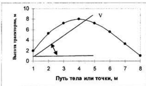
Рис. 44. Траектория полета спортивного снаряда. Двойной стрелкой отмечен угол вылета как угол между горизонталью и вектором скорости ( V )
