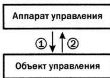
Рис. 56. Система управления. Стрелками показано движение управляющей информации по каналам прямой (1) и обратной связи (2).
