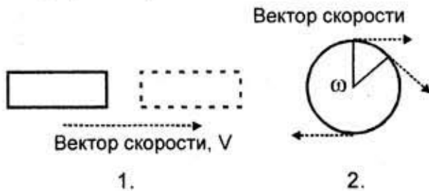
Рис. 8. Направление вектора скорости поступательного (1) и вращательного (2) движения
