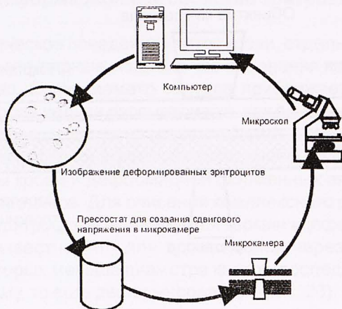
Рис. 30. Схема установки для регистрации изменения деформируемости эритроцитов.
