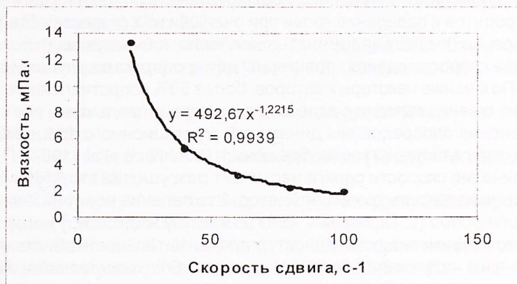
Рис. 15. Изменение кажущейся вязкости крови человека ( \text{Hct} = 40\% ) при низких и высоких скоростях сдвига (представлено кривой течения жидкости степенного закона вида: y = ax^n ).
