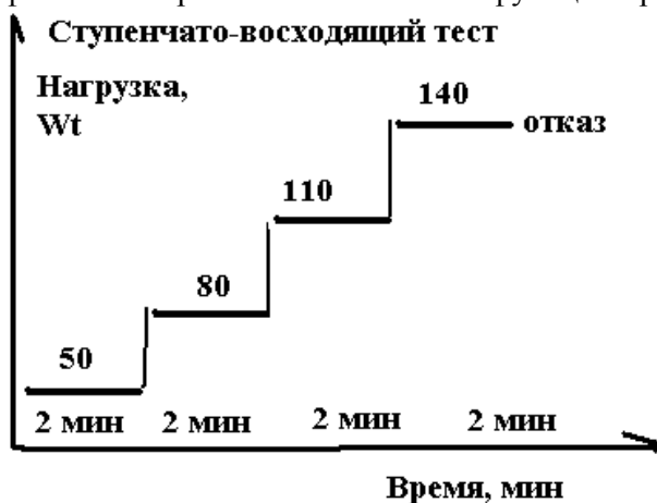
Рисунок 18. Модель ступенчато-восходящего теста до отказа.
